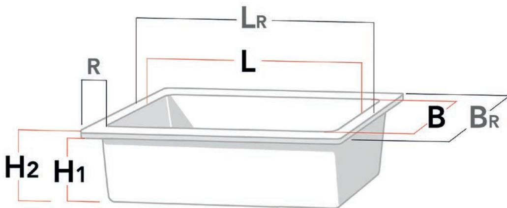
Die nahtlos aus einem Stück gezogenen **florever**-Einbau-Pflanzen-Kunststoffwannen sind garantiert 100% wassererdicht. Bei Hydrobepflanzung empfiehlt unser Team Wasserstands-anzeiger zur Kontrolle.
